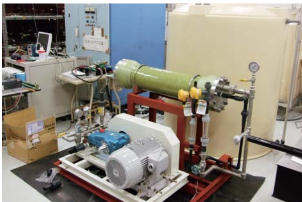
実験用の小型海水淡水化装置
